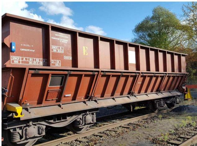
La **digitalisation du fret ferroviaire** permet, grâce à des wagons équipés de boîtiers et de capteurs, d'une part d'obtenir des informations sur leur géolocalisation, les niveaux de température, d'hydrométrie et de pression, et les chocs subis et d'autre part d'établir une liaison digitale entre les wagons et la locomotive.
